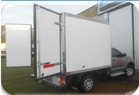
MARCOS y PUERTAS fabricadas con perfilería y placas de anclaje interno
