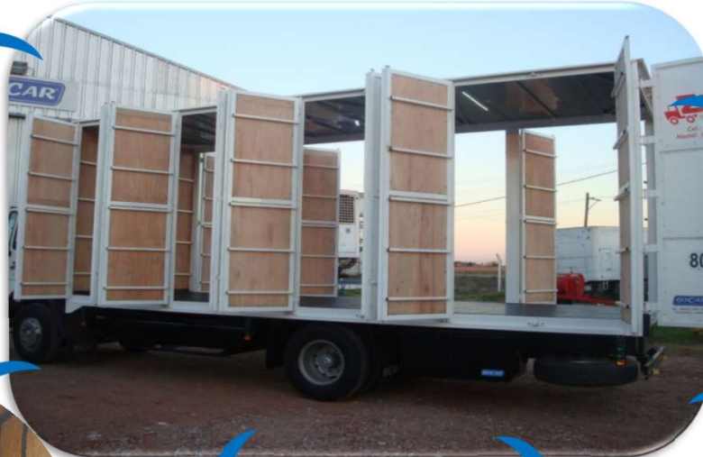
Láminas de P.R.F.V pegadas al FENOLICO u O.S.B (interior) reforzadas con estructuras
