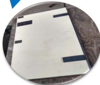
MARCOS y PUERTAS fabricadas con perfilera y placas de anclaje interno
