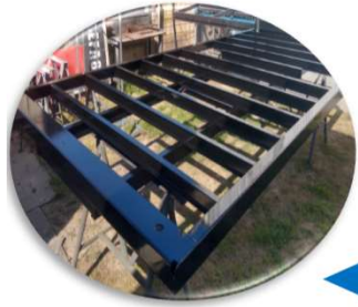
BASES Metálicas, con perímetro de chapas estampadas y teleras de I.P.N
