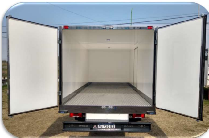
MARCOS y PUERTAS fabricadas con perfilera y placas de anclaje interno
